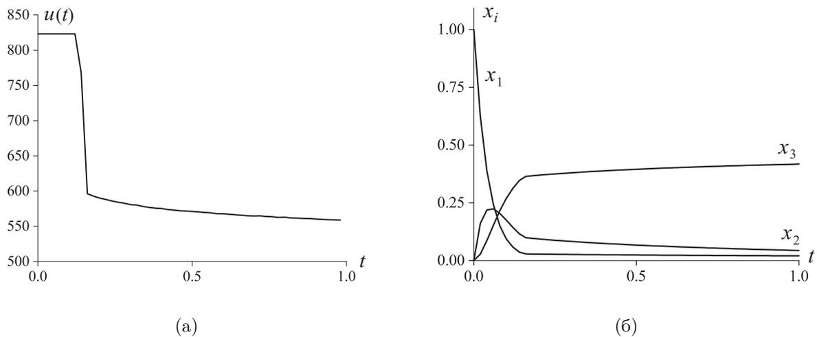
Рис. 4. Решение задачи оптимизации химического реактора с терминальными ограничениями: (а) график субоптимального управления; (б) график фазовых координат
