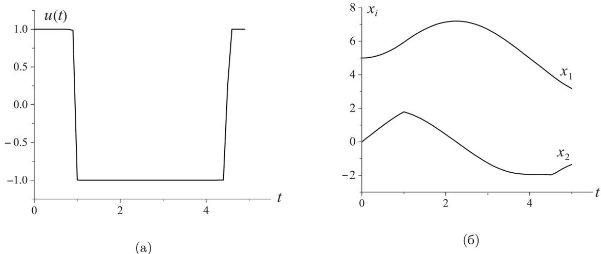
Рис. 2. Решение задачи оптимального управления (4.5)–(4.8): а) график субоптимального управления; б) график фазовых координат.
